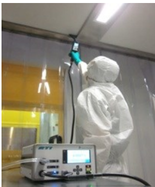
Test di tenuta in campo mediante scansione manuale
